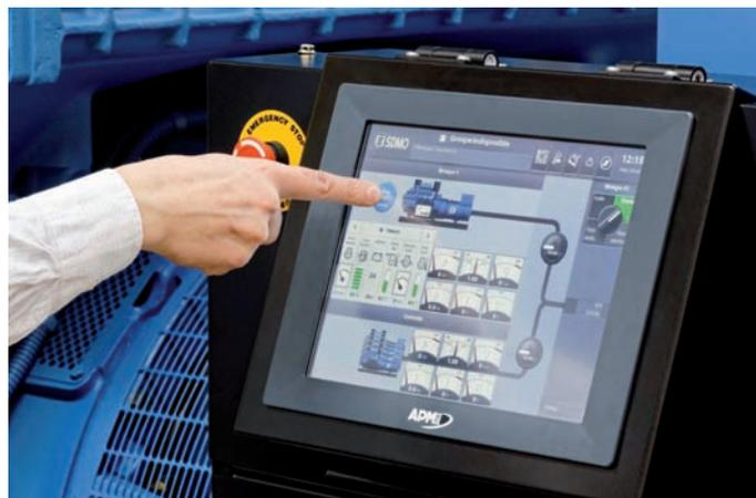
agréable à utiliser grâce à son écran 12' entièrement tactile. L'ergonomie a été étudiée pour faciliter les tâches de surveillance et de conduite de la centrale d'énergie.
